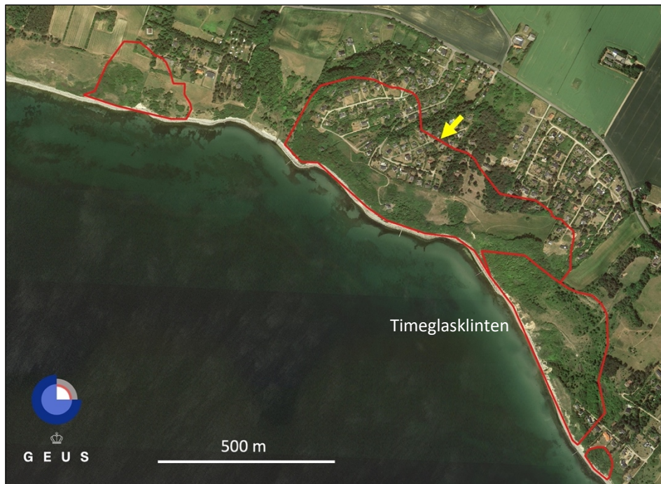
Figur 1. Kortlagte skred ved Kongstrup, Røsnæs. Figuren viser et satellitbillede af sommerhusområdet med skreddene afgrænset af røde linjer. Den gule pil viser, hvor bagvæggen er højest (6 m).
